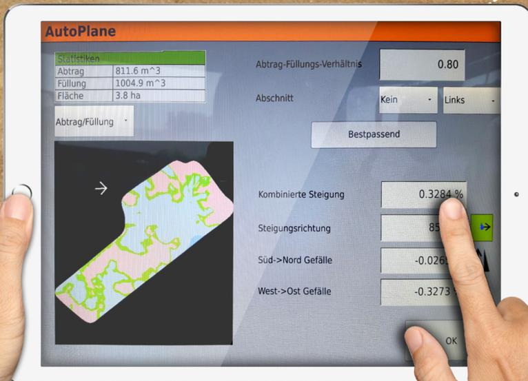
Es dreht sich alles um die Technik in der Kabine, hier ist quasi das Rechenzentrum. Auf dem Planierschild sitzen 2 Empfänger, die permanent ein Höhensignal erhalten und aufgrund dieses Signals das Planierschild autonom steuern. **DIE HÖHE WIRD AUTOMATISCH ANGENOMMEN - WIE VON ZAUBERHAND.**
