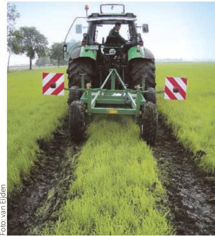
Das Unterschneidegerät im Einsatz. Flurschaden bei zu feuchtem Boden.
