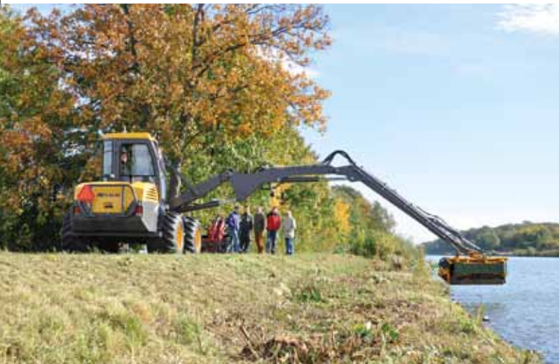
Der Mecalac Mobilbagger 12 MTX weist als Besonderheit einen knickgelenkten Unterwagen auf und kann eine Reichweite von 9,5 m erreichen.
