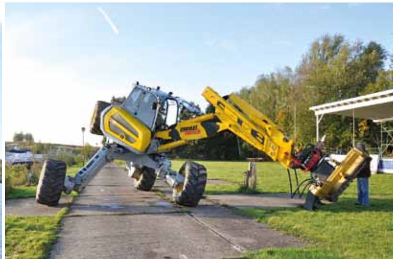
Der Menzi Muck Schreitbagger verfügt über vier unabhängig voneinander steuerbare Schreitbeine.
